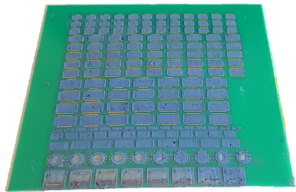
(b) Spulen-PCB-Abschnitt nach ALD
