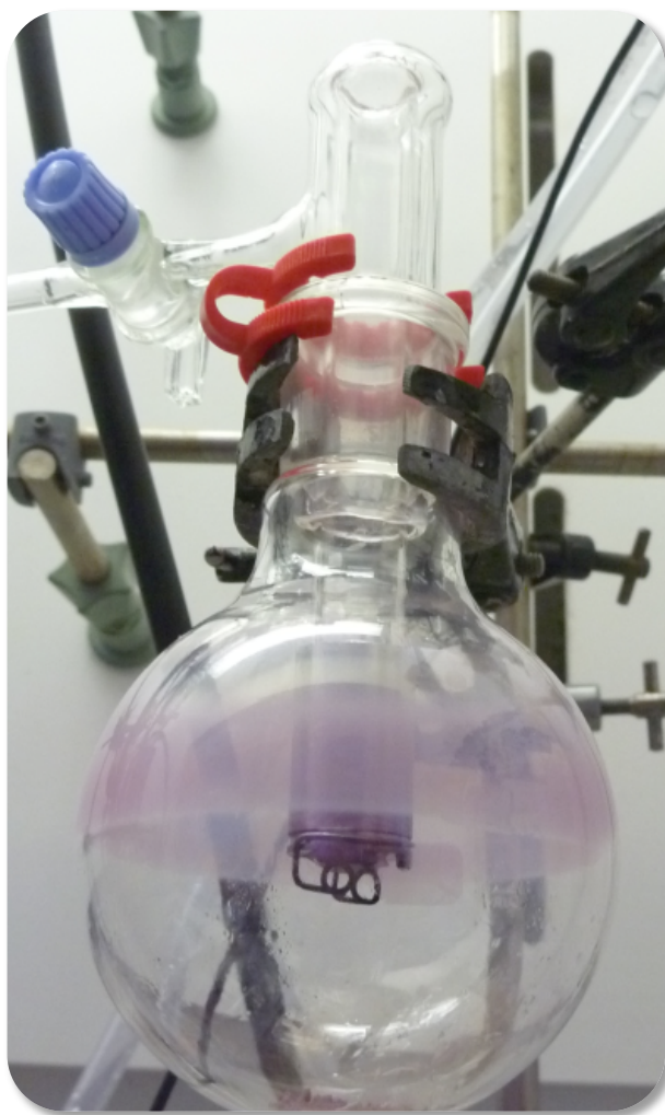
Abb 5.1.: Sublimationsapparatur (links) mit Probenhalter und die technische Zeichnung des Probenhalters(rechts). 33
