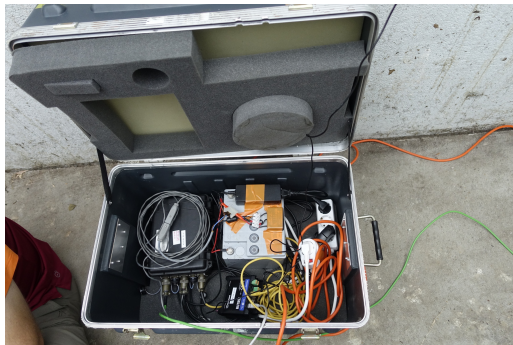
(c) Datenrekorder (links), Pufferbatterie (Mitte) und LTE Modem (vorne mittig)
