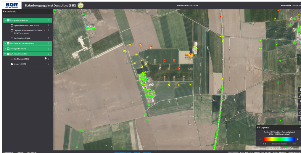
Abbildung 21: Bodenbewegungen an den Kavernenspeichern in Bad Lauchstädt, Skala \pm 5 \text{ mm/a}
