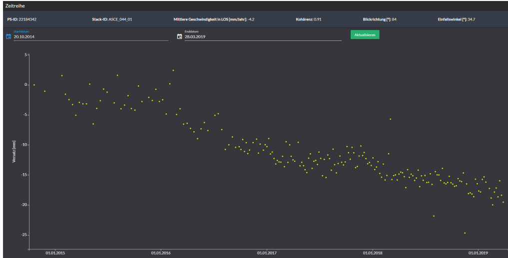
Abbildung 23: Zeitreihe des Rückstreuers mit der höchsten Setzungsrate auf dem Betriebsgelände der Kavernen Kiel-Rönne
