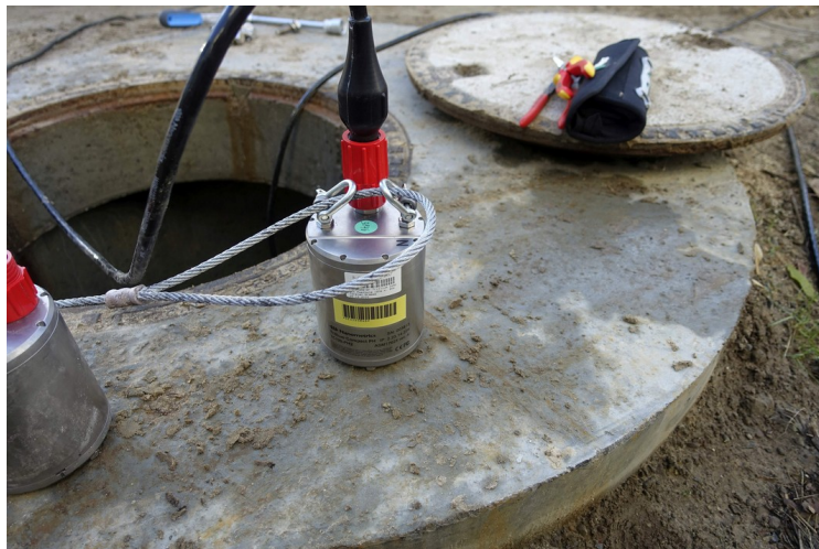
(d) Seismometer Nanometrics Trillium Compact 120PH.
