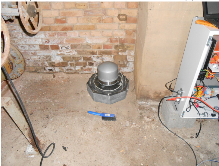
(c) STS2-Seismometer auf Granitsockel, rechts Schaltschrank.
