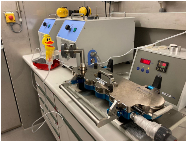
Abb. 1 ◀ Versuchsaufbau mit Vakuumpumpe (links im Hintergrund), Trigger-Box (rechts im Hintergrund), NGI (Next Generation Pharmaceutical Impactor) mit Filter und Rachen (Vordergrund), Vernebler und Kompressor (links im Bild)
