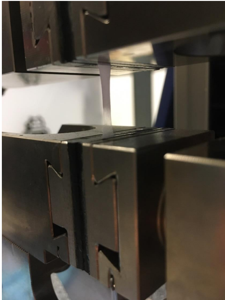
ABB. 6: ZUGTESTUNG EINES PCL-GEWEBESTÜCKS. PCL-GEWEBESTÜCK EINGESpanNT IN DER MATERIALPRÜF-MASCHINE WÄHREND DER TESTUNG, PCL = POLY-ε-CAPROLACTONE.
