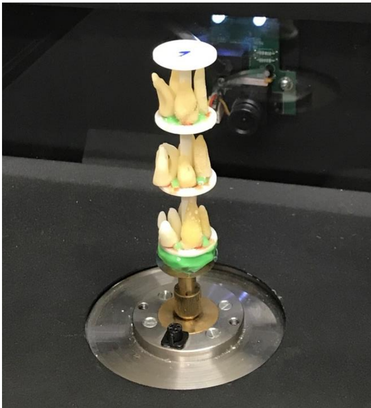
Abbildung 2: Platzierung der Kunststoffhalterung mit den Echtzahnwurzeln auf dem Probenhalter des Mikro-CTs
