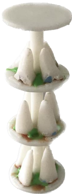
Abbildung 9: Befestigte, wurzelgefüllte Prüfkörper auf der Kunststoffhalterung
